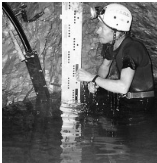
Installation de la sonde Madd et d'une échelle limnimétrique
